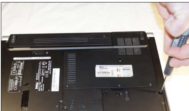
RAM-minnet finns vanligtvis under ett lock på undersidan. Skruva bort skruvarna och öppna.
