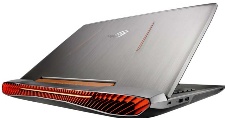
GeForce GTX 1070-grafikkortet ger ifrån sig en hel del värme, så ventilationsskärorna fyller hela baksidan.
