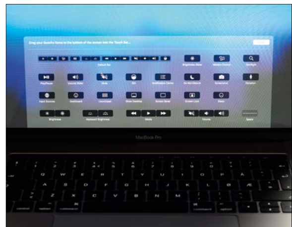
Touch Bar – eller pekfält – kan konfigureras och anpassas sig efter vilket program som körs.
