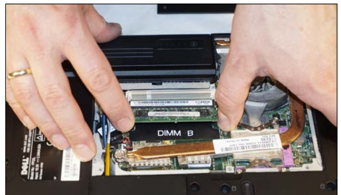
I det här fallet satt det en enda 512 MB-modul. Inte undra på att det gick långsamt! Även om det finns lediga platser så lönar det sig sällan att behålla det gamla RAM-minnet.
