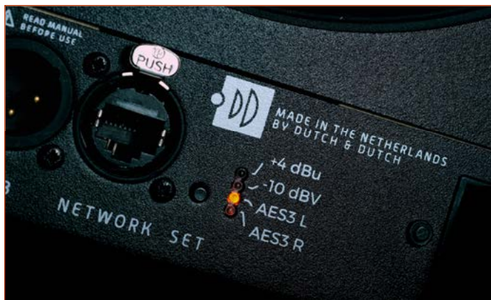
Anslutningarna är professionella XLR-kontakter som både klarar analoga och digitala signaler. Nätverkskontakten används under installationen. (Foto: Dutch & Dutch)
