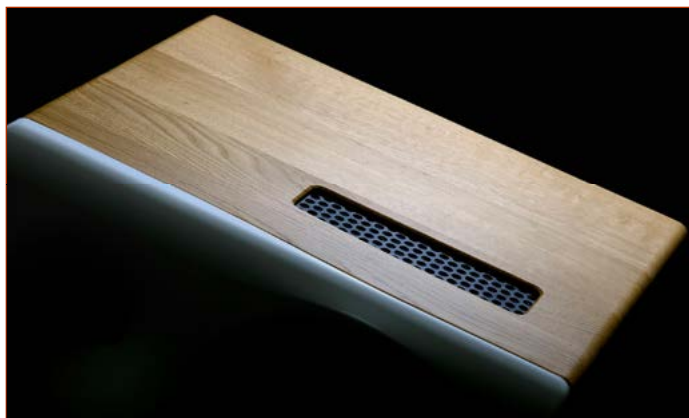
De två "gälarna" på ömse sidor av bas/mellanregistret ger en kontrollerad akustisk kortslutning av elementet, vilket hjälper till att styra spridningsmönstret i basregistret. (Foto: Dutch & Dutch)
