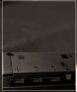
Samsung HW-Q960A har två HDMI-ingångar och en HDMI-utgång med ljudretur från TV:n (eARC). (Foto: Geir Gråbein Nordby)
